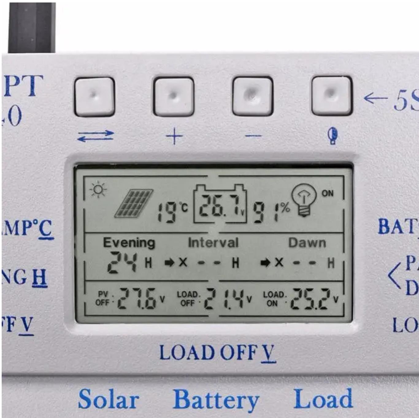
Einstellung des Tiefenentladeschutzes („Deep disch. Settings“) Durch Einstellung des „**Load off**“- Wertes definieren Sie die Batteriespannung, bei welcher der Lastausgang ausgeschaltet wird, um die Batterie vor Tiefenentladung zu schützen. Der „**Load on**“-Wert gibt vor, ab welcher Spannung die Last wieder zugeschalten wird, sofern der Lastausgangsmodus „Auto“ gewählt wurde.
